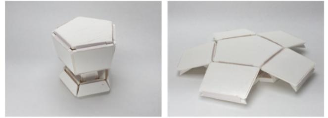
図 11 3D プリンタによって試作した立体模型（左図：折りたたみ前の形状、右図：折りたたみ後の形状）
